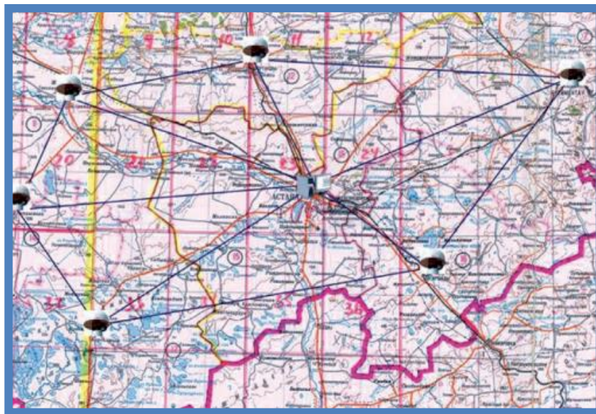
1.9 Сурет – Астана қаласындағы және қала маңындағы аумақтағы референц станциялар желісінің нақтыланған нұсқасы
